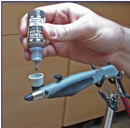
Entgegen der Anleitung wurden alle Farben pur aufgetragen. Die Dosierspitze der Flasche ermöglicht tropfengenaues Einfüllen in den Farbbecher.
