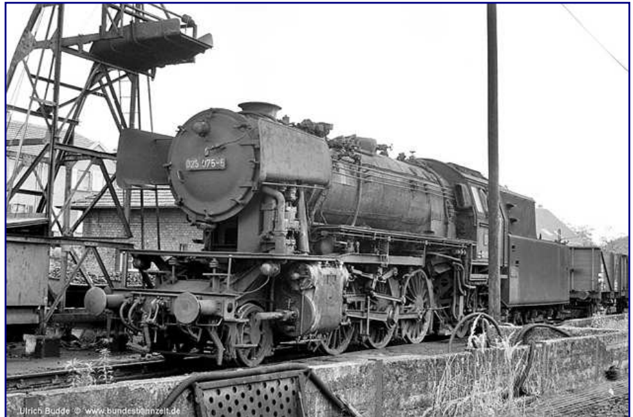
Am 10.9.1973 war 023 075-5 in der Bw-Außenstelle Lebach anzutreffen. Der auf MV 57 zurückgebaute Mischvorwärmer und die Windstauschuten vor dem Führerhaus entsprechen längst nicht mehr dem Ablieferungszustand. Foto: Ulrich Budde (Bundesbahnzeit)
