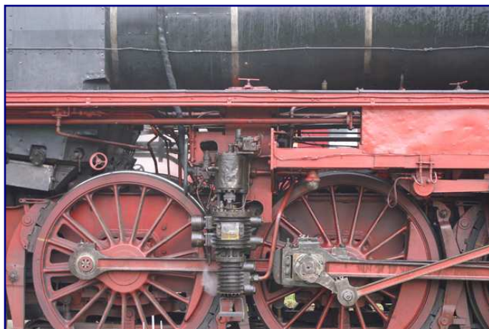
Blick auf Luftpumpe und Treibradgruppe der Museumslok 23 042.
