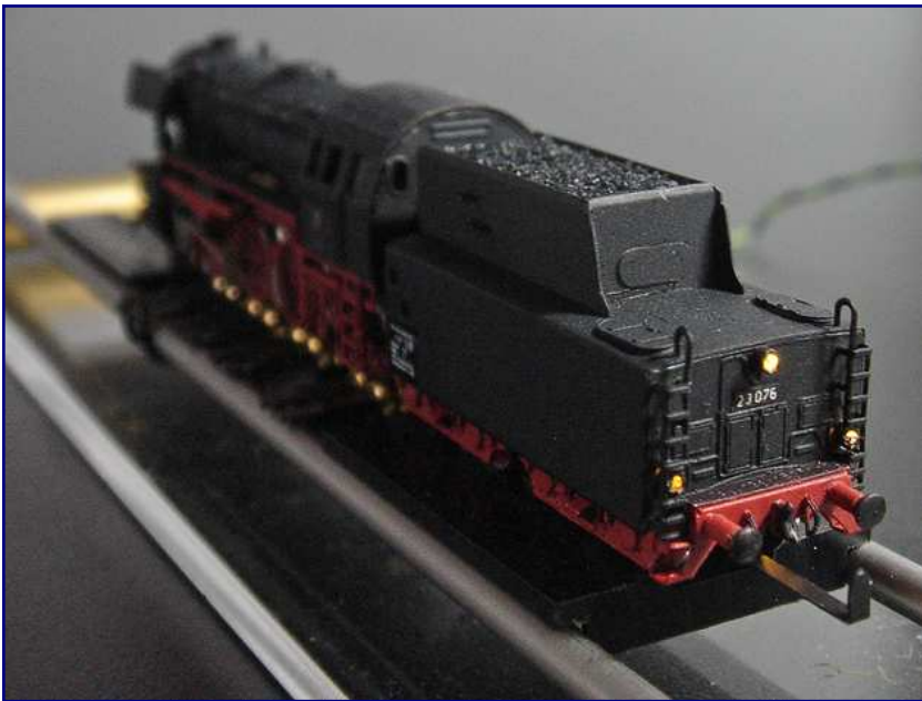
Der Tender mit seinen feinen Details wie den Aufstiegsleitern und der nachgebildeten Wannenförmigkeit ist eine Pracht. Die Laternenbeleuchtung mit warmweißen LED überzeugt mit glühlampenähnlichem Farbspektrum und ist auch bei niedriger Fahrspannung sofort gut wahrnehmbar.
