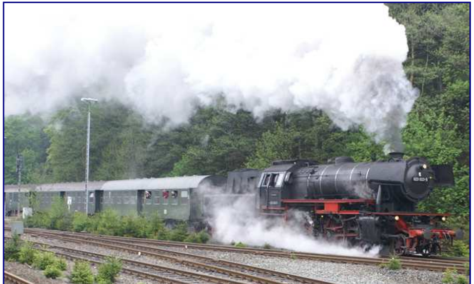
023 023-5 ist in den Niederlanden betriebsfähig erhalten geblieben. Die Lok der zweiten Bauserie besaß bei der Ablieferung bereits eine einfache Führerhausheizung und abgewinkelte Schiebetüren, die später auf Klapptüren umgebaut wurden. Am 13. Mai 2006 fährt sie mit prächtiger Dampfahne aus Brilon Wald in Richtung Korbach aus.
