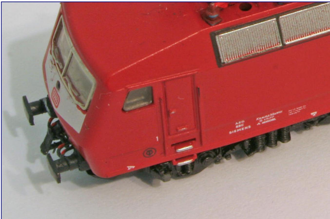
Wesentlich für die Optik des zugerrüsteten Märklin-Modells sind Detailkupplung (Heckl Kleinserien), LED-Beleuchtungseinsatz (High Tech Modellbahnen (im Bild nicht sichtbar) und die eckigen Puffer (Märklin). Foto: Thomas Wycislo
