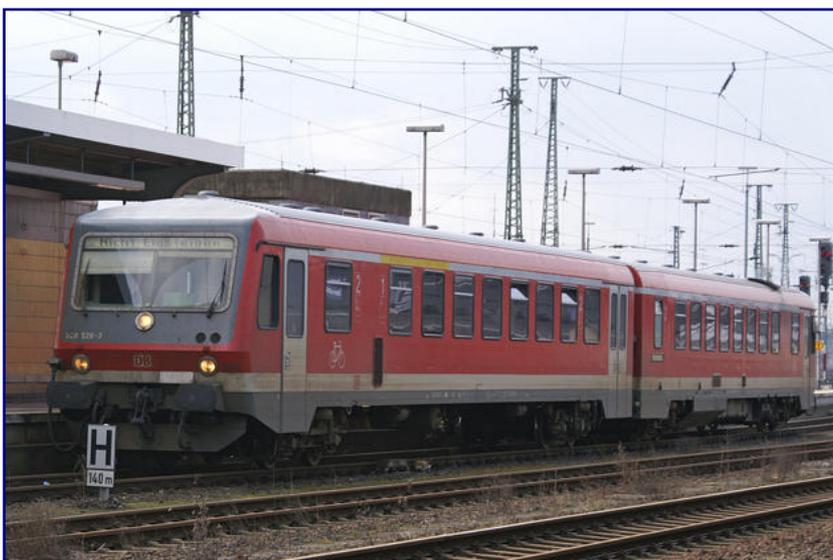
Zwischen 1986 und 1996 gelangen die Fahrzeuge der Unterbaureihen 628<sup>2</sup> mit integrierter Zugzielanzeige (oben) und 628<sup>4</sup> (unten) in den Bestand der DB. Die Änderungen bei dieser letzten Serie betrafen Motor und Getriebe sowie die Türanlagen in der Fahrzeugmitte: Gut zu sehen ist die Doppeltür beim 628<sup>4</sup> gegenüber der vorherigen Einzeltür.
