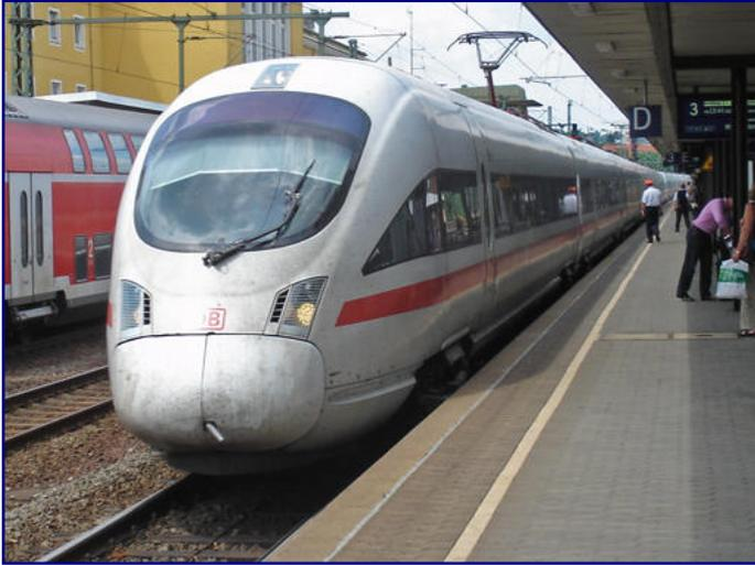
Zu nennen ist zunächst der Anlieferungsbeginn für die Baureihen 411 und 415. Diese ICE-3-Version für Ausbaustrecken bis  $V_{\max}$  230 km/h war ursprünglich als IC-Nachfolger gedacht, wird nun aber als ICE eingeführt. Beschafft werden bis 2000 11 fünfteilige (BR 415) und bis 2006 60 siebenteilige Züge (BR 411).
