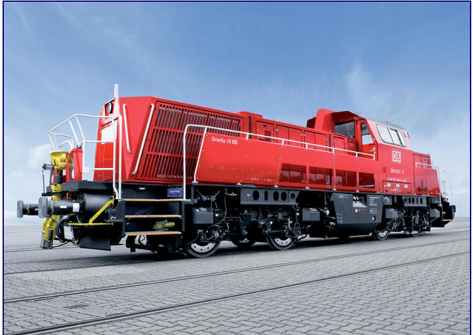
2010 bis 2012 erfolgt die Beschaffung von 130 Exemplaren der Voith Gravita 10 BB durch die DB AG. Sie wird als Baureihe 260 in zweiter Besetzung geführt und löst die Baureihe 290 ab. Foto: Voith Turbo GmbH & Co. KG
