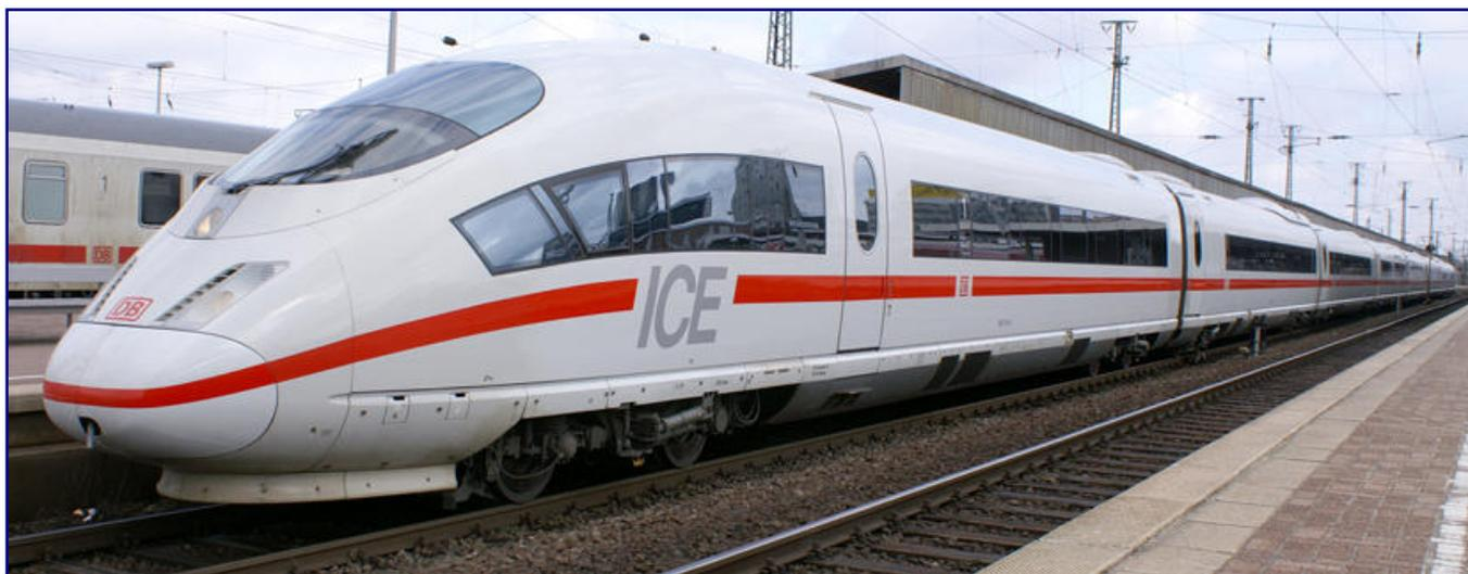
Seit 1999 prägen sie das Gesicht der modernen Bahn. Die ICE 3 der Baureihen 403 und 406. Die schnittige Form der Endwagen weicht stark von der Gestaltung der ersten beiden ICE-Generationen ab.
