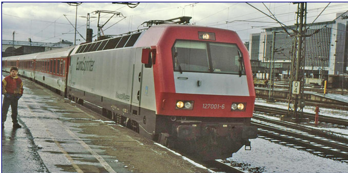
Der auf der Baureihe 120 basierende „EuroSprinter“ von Siemens und Krauss-Maffei wird 1992 die letzte Lok der alten DB. Das angemietete Fahrzeug wird dort als 127 001-6 eingereiht und ausgiebig erprobt – hier im Intercity-Dienst. Der vom DB-Farbschema abweichende Lack weist auf die wahre Eigentümerschaft hin. Foto: Sammlung Späing
