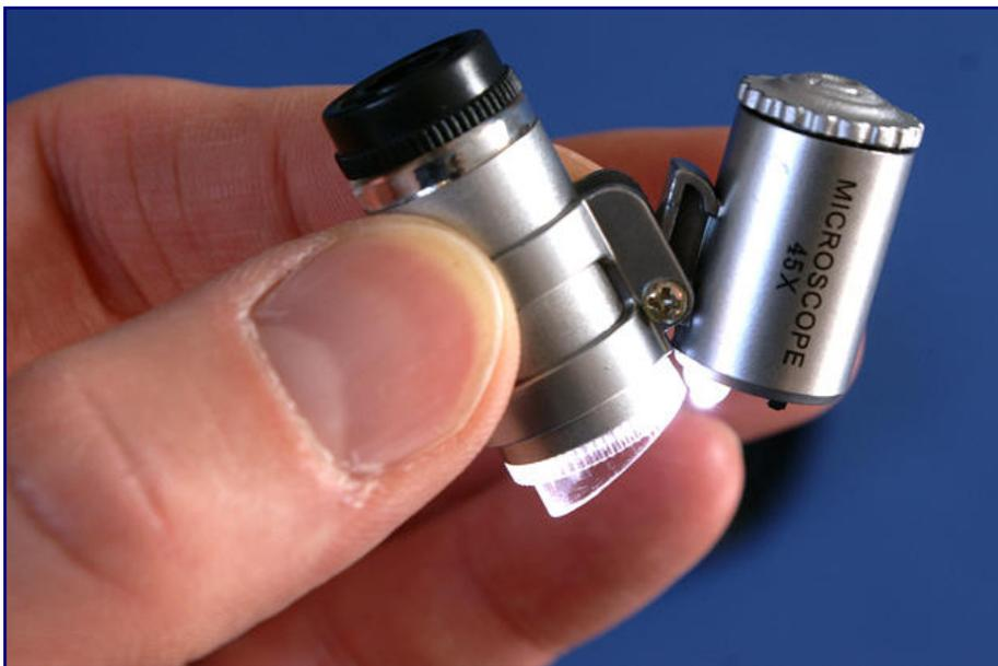
Feinste Unregelmäßigkeiten auf Modellen lassen sich damit aufspüren oder Fehler an Eigenbauten identifizieren. Insgesamt hat das kleine Werkzeug die Bezeichnung LED-Mikroskop allemal verdient, denn seine Leistung liegt weit über dem von Lupen.
