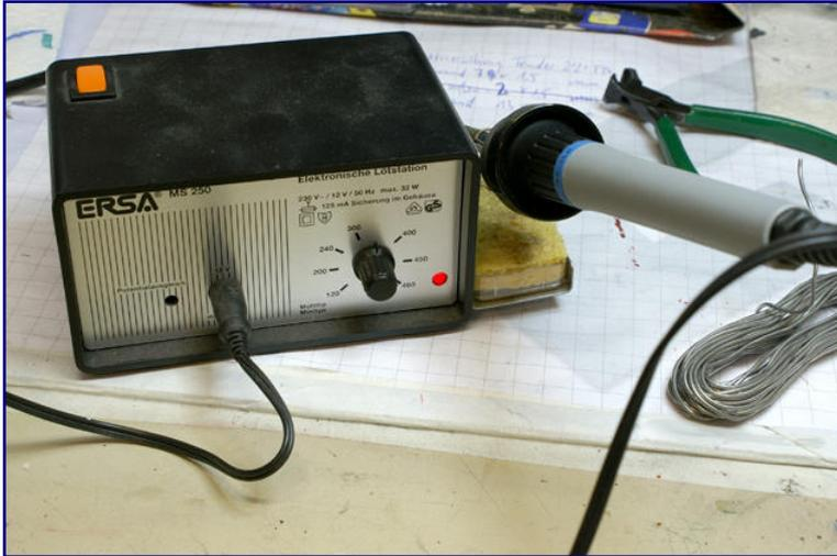
Wichtig für den Erfolg beim Zusammenbau ist die richtige Temperatureinstellung an der Lötstation: Peter Grundmann empfiehlt 300 – 350°C.
