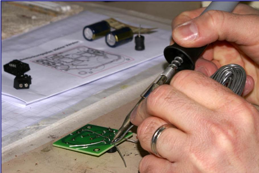
Der Materialkontakt mit der Lötspitze sollte so kurz wie möglich gehalten werden, um Hitzeschäden auszuschließen. Das verflüssigte Lötzinn fließt durch Kapillarkraft in die Montagelöcher und sorgt dort für festen Halt.
