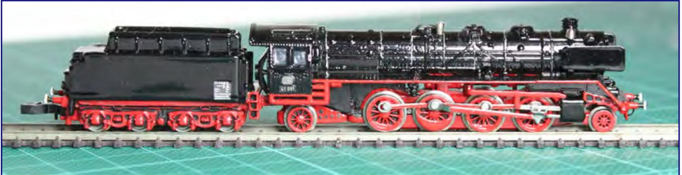
Auch in der Seitenansicht sorgen die durchgeführten Maßnahmen für eine erhebliche, optische Verbesserung: Zwischen den Speichen schwarz hinterlegte Räder, rot ausgelegtes Gestänge, farbliches Absetzen der vorderen Rahmennachbildung, vergrößertes Gegengewicht an der Treibachse und silberfarbene Kesselringe sorgen zusammen mit den Kuswa-Ätzschildern für deutlich mehr Vorbildnähe.
