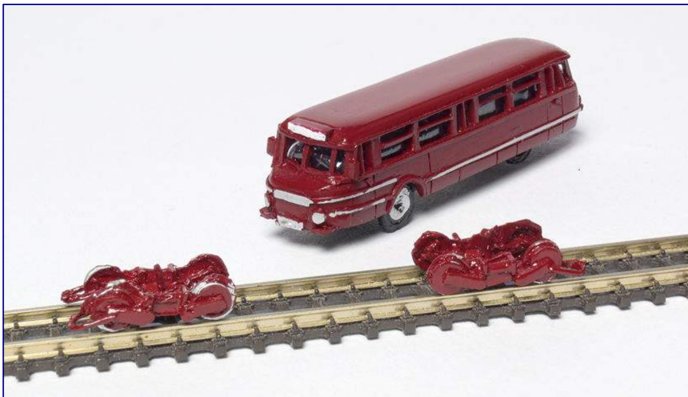
Ausgeliefert wird das noch recht grob wirkende Modell inklusive von zwei ansteckbaren Spurwagen. Damit ist der Einsatz sowohl auf dem Gleis als auch der Straße nachstellbar.
