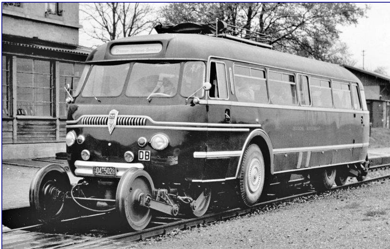
Der Straßen-Schienen-Omnibus (in der Fahrtzielanzeige so bezeichnet) mit dem Besatzungskennzeichen AB 04-5028 zeigt die endgültige Serienausführung von Bus und Spurwagen im Jahr 1954, die auch für das Spur-Z-Modell ausgewählt wurde. Gut zu sehen sind die vorderen und hinteren Einstiegstüren auf der linken Fahrzeugseite, eine Sandstreueinrichtung an den Spurwagen fehlt noch. Der Dachgepäckträger ist nur bei einem Teil der Schi-Str-Busse zu sehen. Foto: Below, Eisenbahnstiftung
