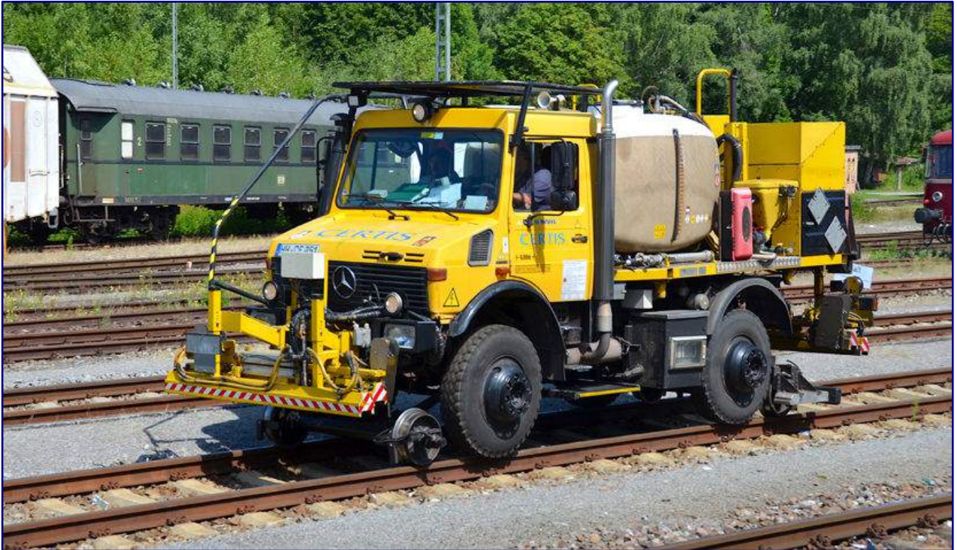
Die größten Schwachpunkte des von der Bundesbahn gewünschten Systems wurden mit dem Prototyp V4 beseitigt. Die Verbesserungsvorschläge seines Konstrukteurs nahmen bereits die Entwicklung vorweg, die auch heutige Zwei-Wege-Fahrzeuge erfolgreich macht, so wie den am 22. August 2019 im Bahnhof Rottweil aufgenommenen Certis-Unimog zur Vegetationsbekämpfung. Foto: Olga Ernst (CC-BY-SA-4.0)
