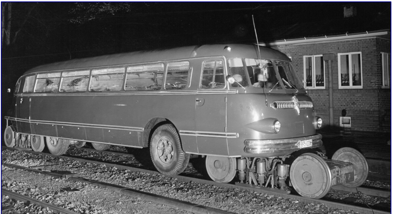
Auf dieser undatierten Werksaufnahme ist eines der Fahrzeuge, zugelassen in Wilhelmshaven, bei Probefahrten mit modifizierten Spurwagen der Prototyp-Bauart unterwegs. Drei Bremszylinder je Seite wirken hier nicht auf die Scheibenräder, sondern eine Gleisauflage, die ähnlich einer Magnetschienenbremse aufs Gleis gepresst wird. Foto: Werksaufnahme NWF, Archiv Bernd Coldewey
