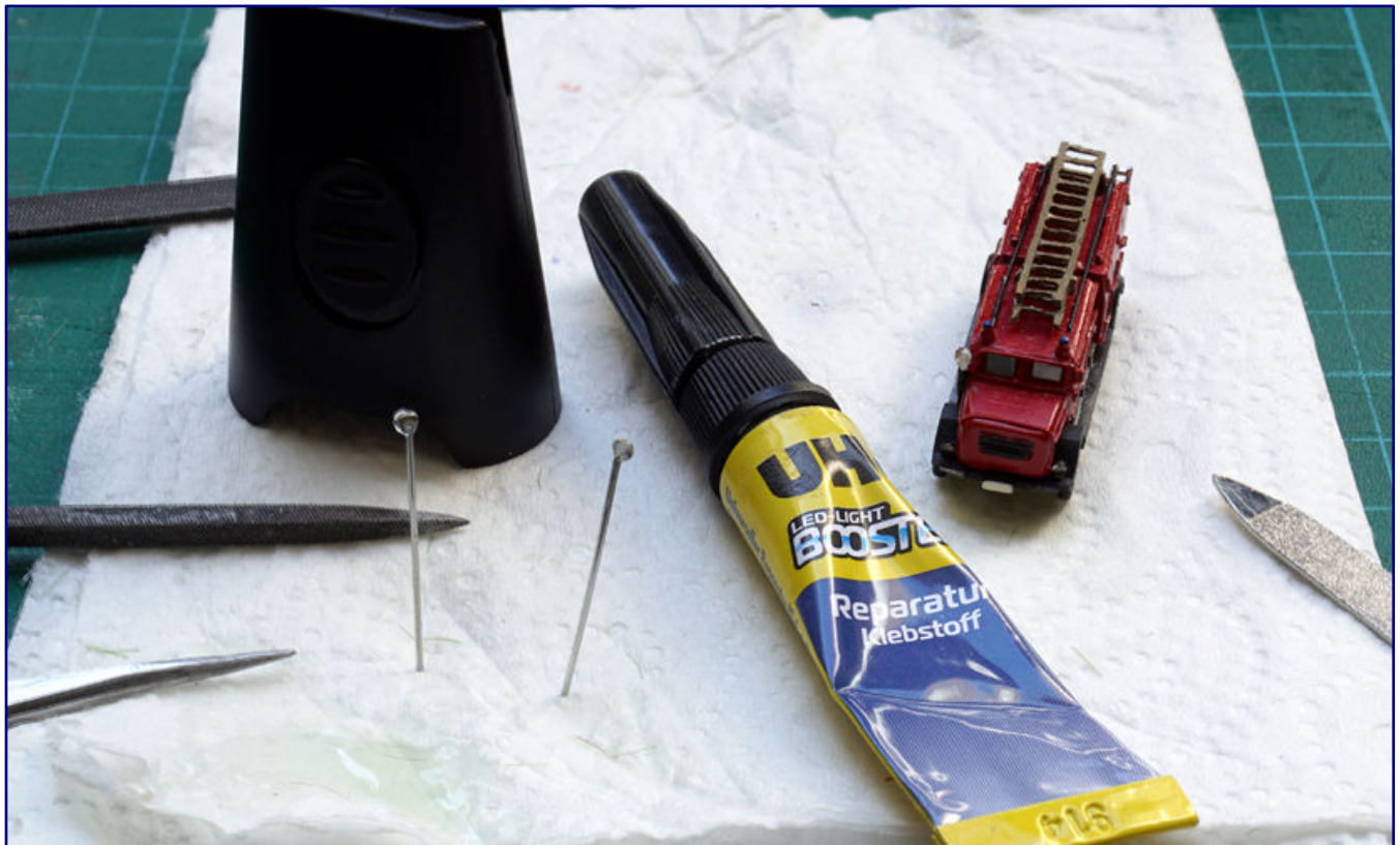
Die halbkugelförmigen Scheinwerfer für die Umfeldbeleuchtung modellierten wir mit Hilfe des UV-Klebers „Uhu LED-Light Booster“. Die Basis bildeten zwei abgeschliffene Stecknadelköpfe (links neben der Tube). Für einen Vorabtest zogen wir eines der Magirus-Löschfahrzeuge vom 1zu220-Shop heran, bei dem dieser Scheinwerfer auf einer Ausstellung abgebrochen war (rechts im Bild).
