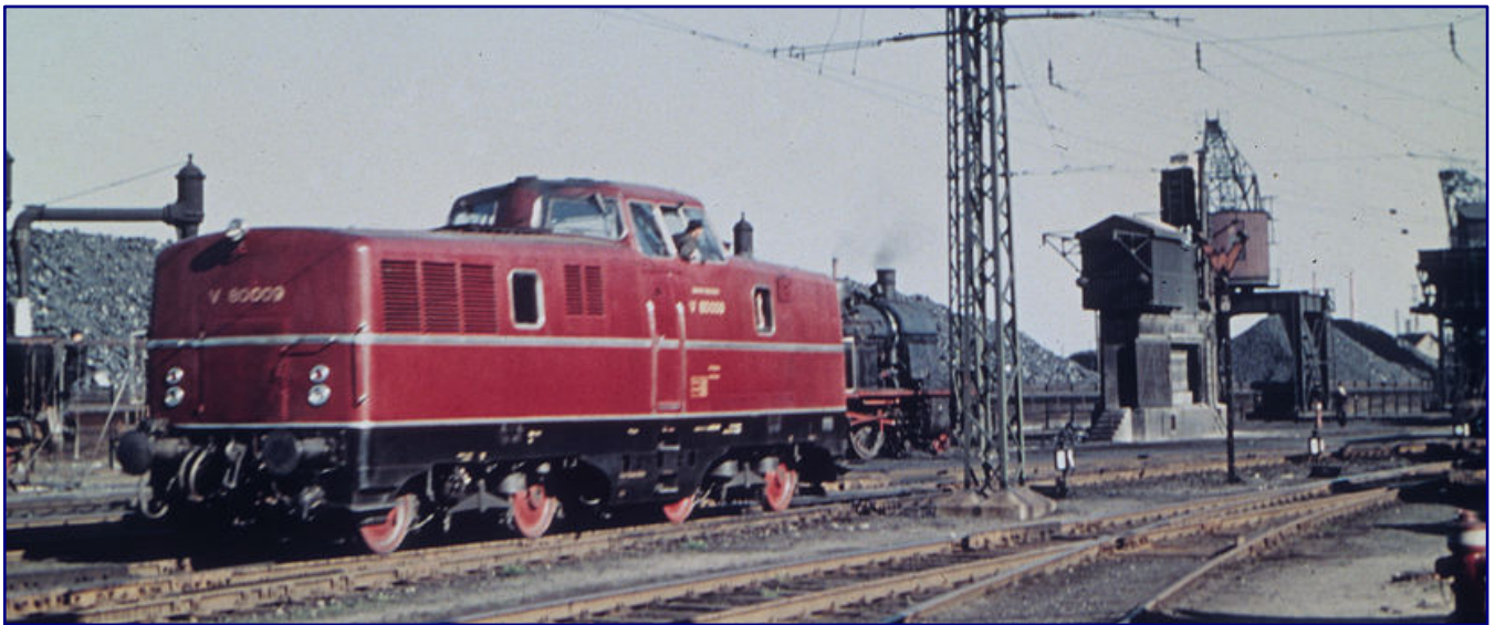
Als die V 80 das Licht der Welt erblickte, bestimmte die Dampflokomotive noch das Alltagsbild, hier im April 1956 in Nürnberg, als dem Fotografen V 80 009 durchs Bild fährt. Interessant ist das nur provisorisch montierte, obere Spitzenlicht. Foto: Sammlung Peter Pfister
