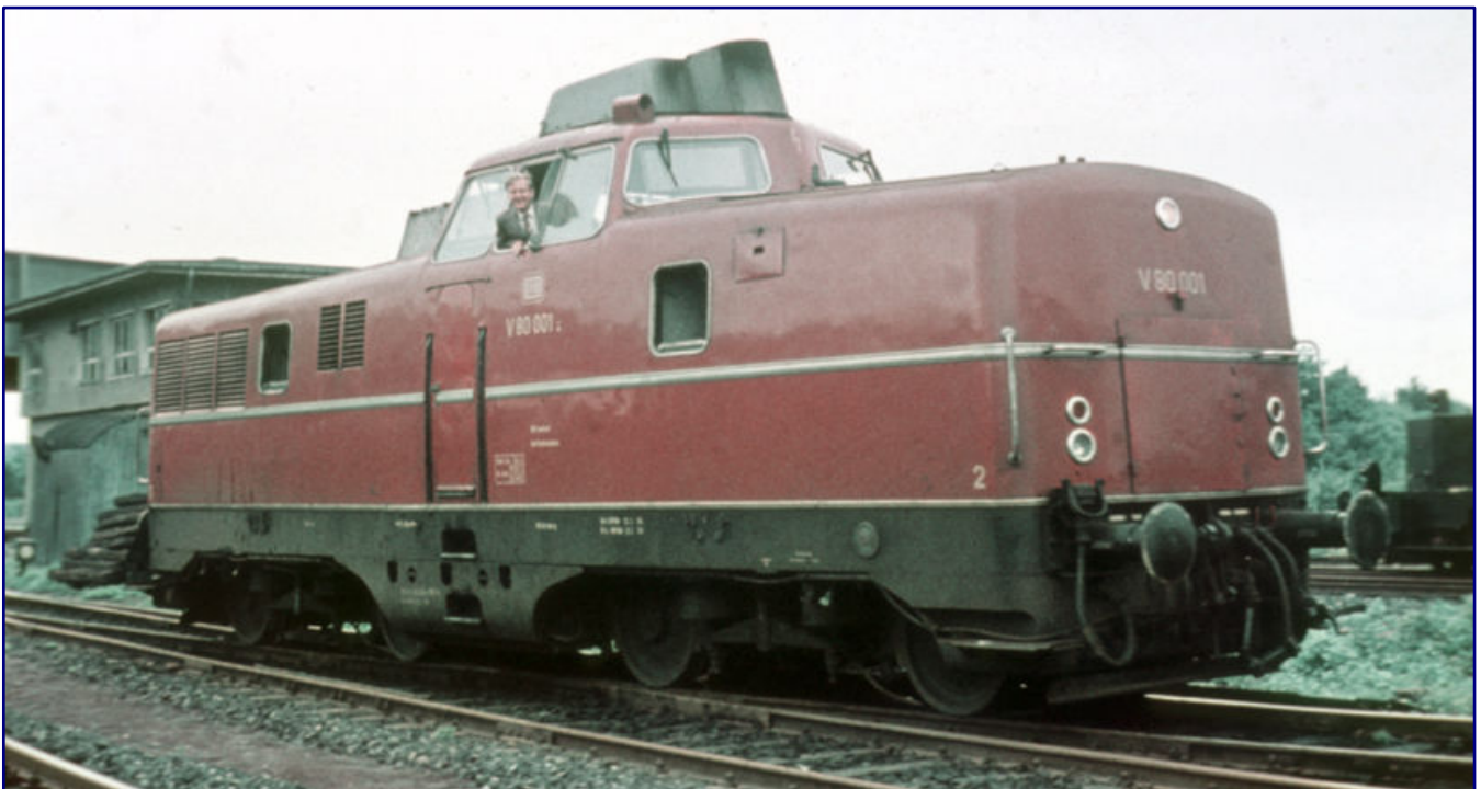
V 80 006, aufgenommen am 26. Mai 1960 in Nürnberg Hbf (Bild oben), erhielt während eines AW-Aufenthalts vom 12. Februar bis 12. April 1957 als erste Lok einen Schalldämpfer, der sich durch die Kastenform mit Kühlschlitzen deutlich von dem der anderen Maschinen unterschied (vgl. V 80 001; Bild unten). Und obwohl die Lautstärke im Führerraum dadurch messbar gesenkt werden konnte, blieb das Grundproblem dieser Baureihe bestehen: Nach heutigen Arbeitsschutzbestimmungen hätte sie trotzdem nur mit Hörschutz bedient werden dürfen. Fotos: Helmut Röth, Eisenbahnstiftung (Bild oben) / Sammlung Peter Pfister (Bild unten)
