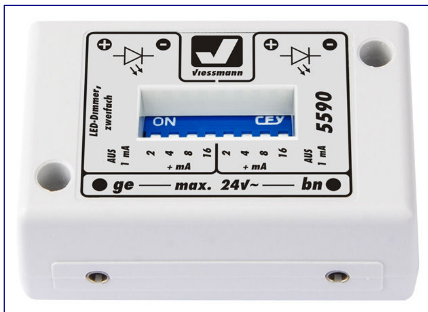
Das Modul „LED-Dimmer, zweifach“ (Art.-Nr. 5590) unterstützt Beleuchtungswünsche auf der Modellbahnanlage. Foto: Viessmann
