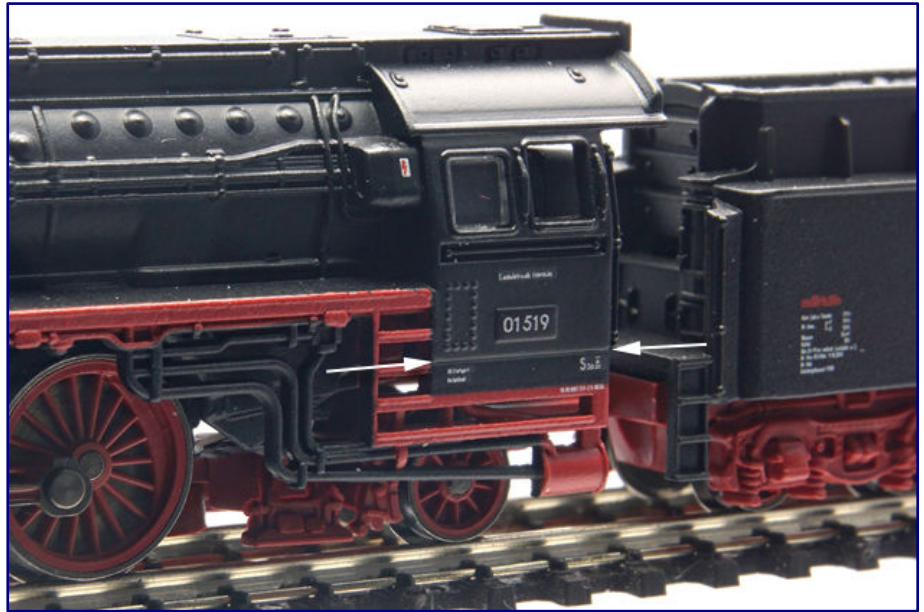
Beim Vorbild erhielt die Baureihe 01 5 ein neues, geschweißtes Führerhaus, bei Märklin eine Phantasieumsetzung: Das Verhältnis der Länge zur Höhe stimmt nicht, die mit Pfeilen markierte Kante widerspricht komplett dem Vorbildeindruck.
