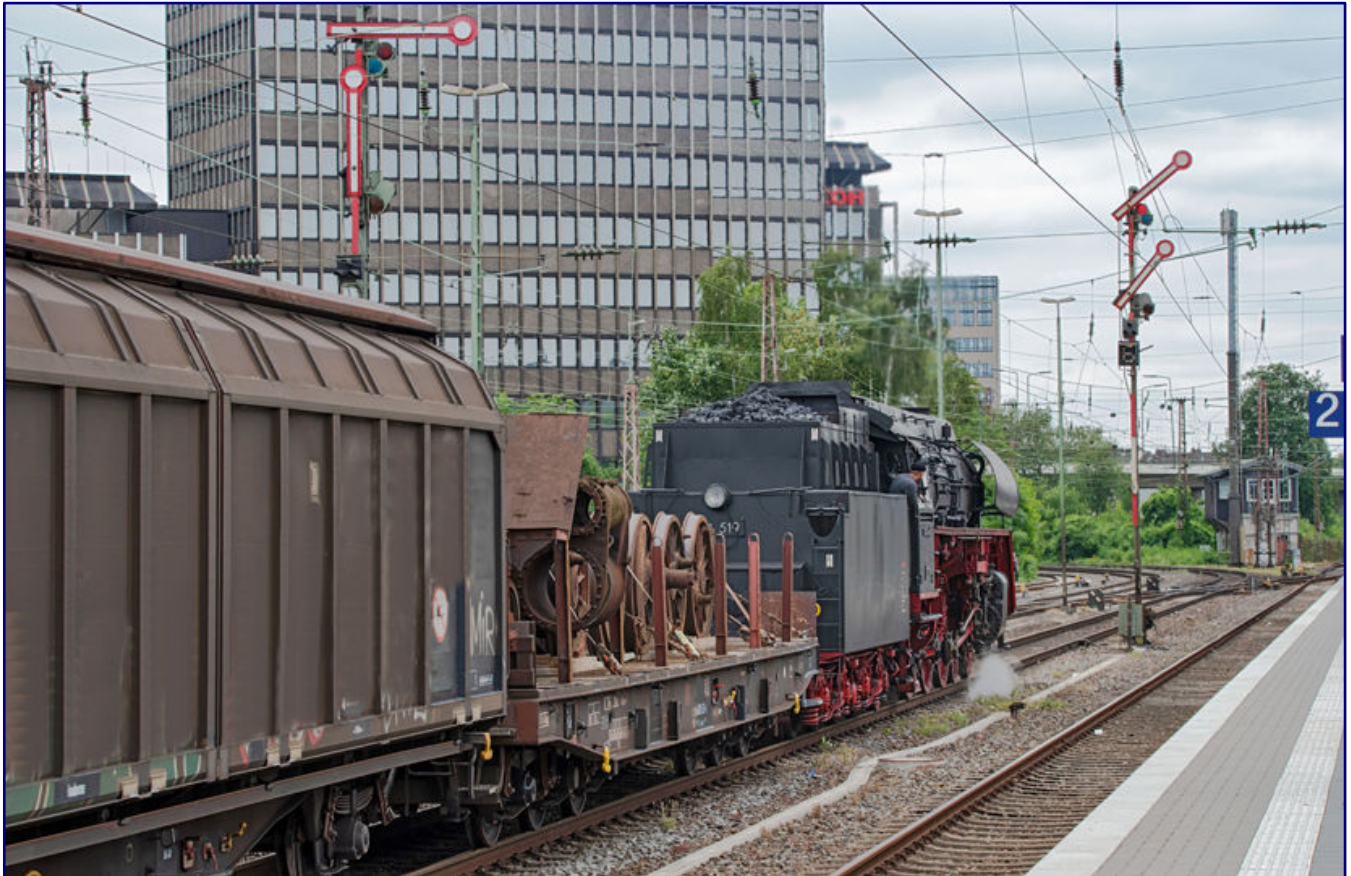
Bei 01 519 schließt sich der Kreis: Die Vorlage des Märklin-Modells überlebte als Heizlok in Form eines Torsos, bevor sie wieder vervollständigt und aufgearbeitet wurde. Beim Nachschuss am 24. Juni 2018 belegt die Tenderansicht die beim Modell fehlende Kohlenkastenerhöhung. Foto: Marcus Henschel, Sammlung Eisenbahnstiftung
