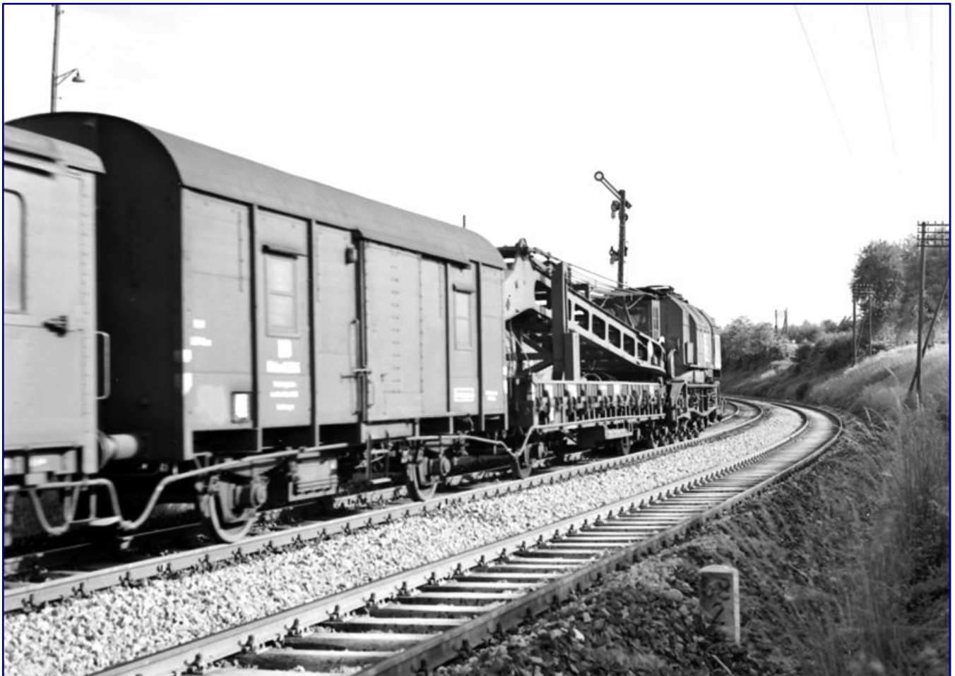
Der Ardelt-57-t-Dampfkran „Mainz 6600“ befindet sich am 22. Juni 1968 bei Schwäbisch Hall-Hessental auf der Fahrt zu einem Einsatzort. Sein Ausleger ruht auf dem Kranschutzwagen „Mainz 6650“. Foto: Heinz Hangarter, Slg. Eisenbahnstiftung.
