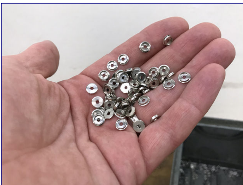
Mit offenen Augen beim Rundgang entdecken wir Drehteile für Spur-Z-Räder in der Dreherei des Märklinwerks Göppingen.
