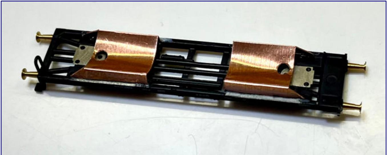
Das bearbeitete Fahrwerk ist mit neuen, größenrichtigen Puffern bestückt und auch die Sattelbleche sind eingesetzt. Zuvor wurden diese abgekantet, in der Mitte ausgerundet und mit einer Bohrung versehen.
