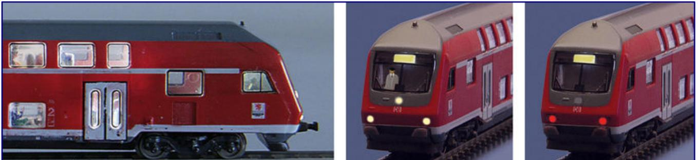
Die Ausführung WBL-Z-D-03-6/4NW (32 02 38) für den Steuerwagen beinhaltet auch schaltbares Spitzen- und Schlusslicht, aber der dafür erforderliche Funktionsdecoder liegt ab Werk nicht bei. Fotos: Mobatron
