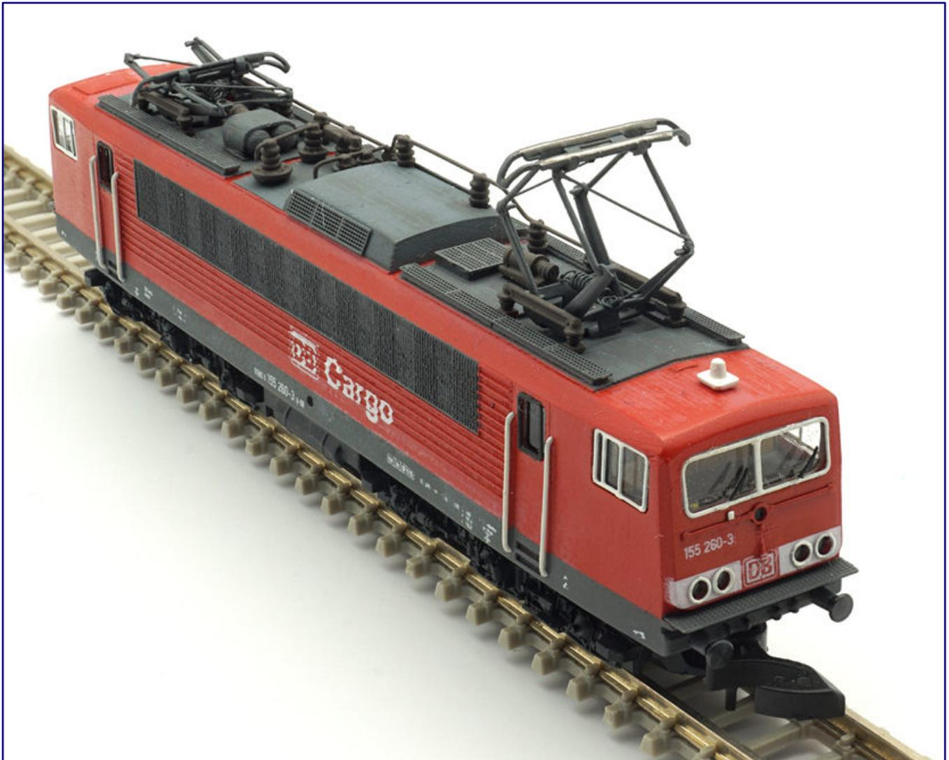
Anerkennung verdienen auch die vollständige Dachausrüstung, feinen Dachleitungen und die eingelöteten Diagonalstreben der Scherenstromabnehmer.
