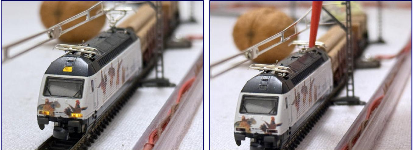
Die Relax-Lok hängt mit Stromabnehmer am Fahrdrabt und wird elektrisch über diesen versorgt (Bild oben), wie am Spitzenlicht abzulesen ist. Wird dieser heruntergedrückt (Bild rechts), erlischt es folglich.
