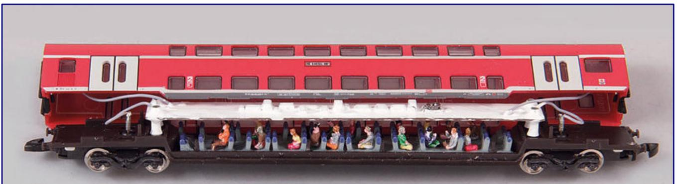
Die Innenbeleuchtung WBL-Z-D-04-6/4NW (Art.-Nr. 32 02 39) für Mittelwagen veranschaulicht hier den gemeinsamen Einbau mit einer Inneneinrichtung. Foto: Mobatron
