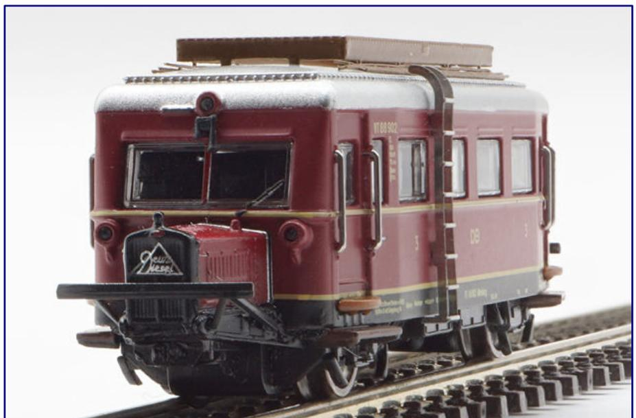
Vorne prangt das Deutz-Diesel-Logo gut sichtbar an der klar vom Wagenkasten abgesetzten Motorhaube. Über den Frontfenstern erkennen wir das Zweitton-Horn, umgeben von den drei mit LED beleuchteten Laternen für Spitzen- und Schlusslicht.
