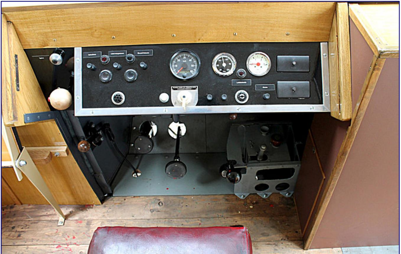
Der modernisierte Führerstand eines Wismarer Schienenbusses des Baujahrs 1933 zeigt mit Schaltung und Fußpedalen deutlich, dass er technisch doch nur ein auf Schienen gestellter Omnibus ist. Foto: Jacek79 (CC-BY-3.0)
