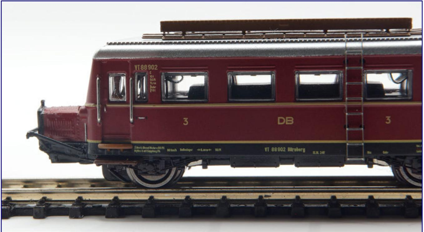
Auf Rahmen und Wagenkasten finden wir viele Anschriften, die lupenrein gedruckt sind, bei weitem aber nicht so fein wie bei anderen Märklin-Modellen. Gut zu sehen ist auf diesem Foto auch das Sandfallrohr, das vor die erste Achse führt. Als zu groß erweisen sich bei genauem Hinsehen die vier Bohrungen für die Halter der Leiter.
