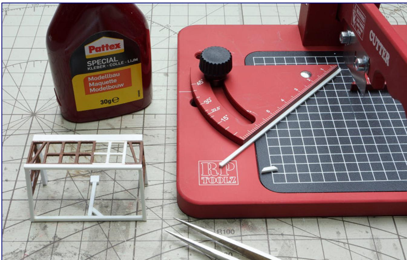
Mit Hilfe des Hebelschneiders von RP Toolz (RP-CUTR) gelingt das Ablängen der PS-Profile für den Betonsockel der Fahrzeughalle schnell und präzise (Bild oben). Auch die Gehrungsschnitte für alle schrägen Balken im Dachbereich und Ständerwerk gelingen mit diesem Werkzeug perfekt (Bild unten).
