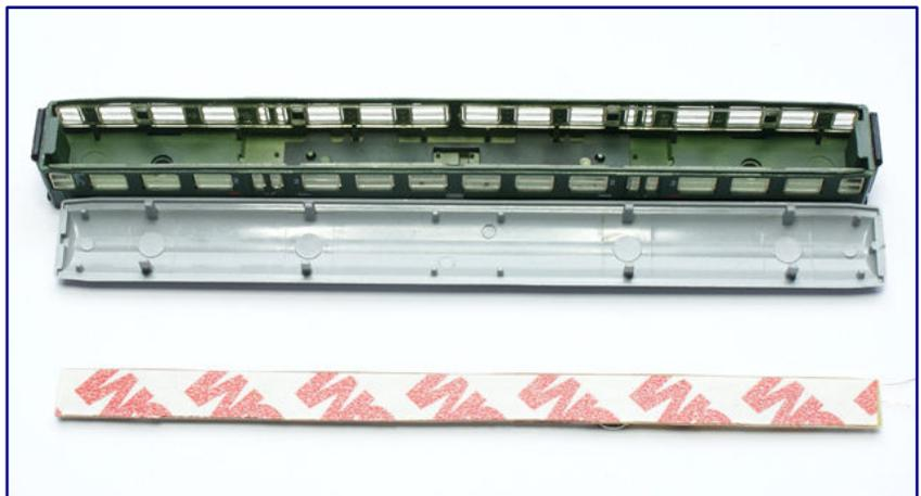
Die Lichtplatine wird ins Dach des Modells geklebt. Dafür ist ein doppelseitiges Klebeband schon befestigt. Der Schritt wird aber erst vollzogen, wenn der elektrische Kontakt zur Platine hergestellt ist.
