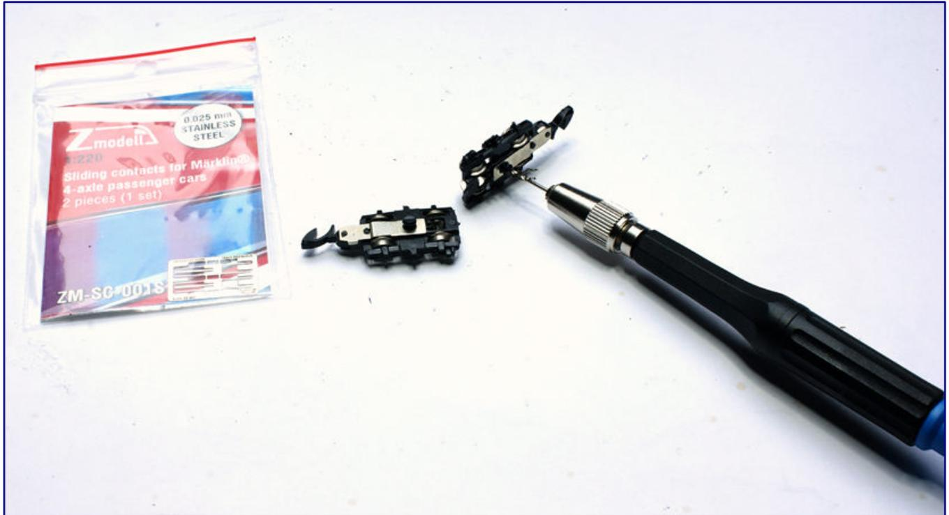
Wir nutzen Edelstahl-Achsschleifer von Zmodell (Art.-Nr. ZM-SC-001S). Um sie montieren zu können, müssen wir zuvor die Drehzapfen mittig durchbohren.
