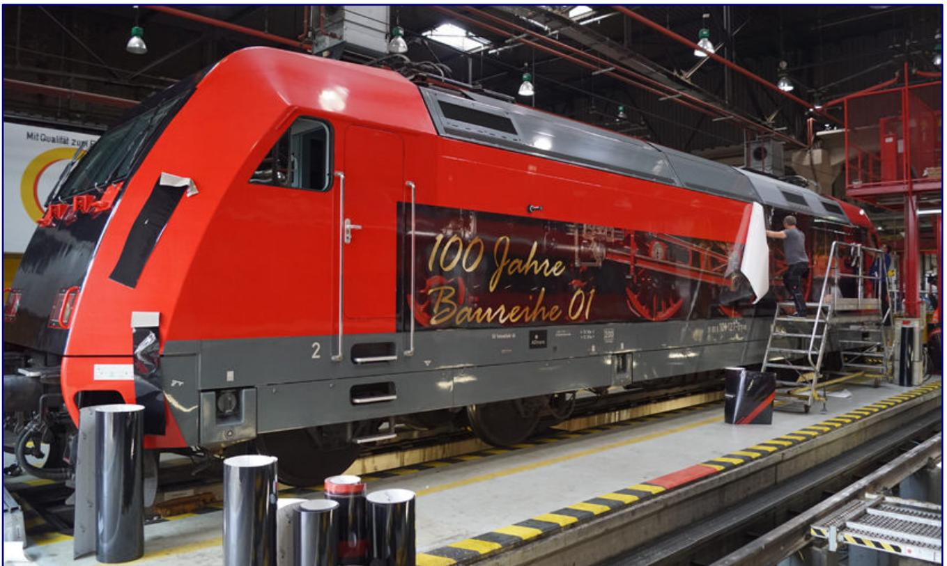
Inzwischen wird das Motiv an der Loklängsseite erkennbar: Die dritte von vier der großen Rollen wird ausgerichtet und auf die Seitenwand geklebt.
