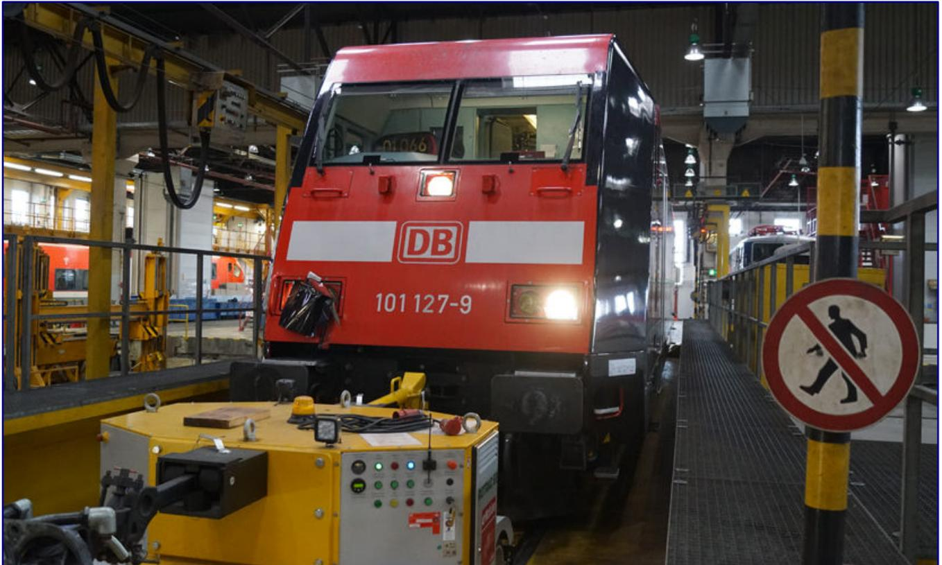
Zum Bekleben der zweiten Stirnseite muss 101 127-9 innerhalb des Lokschuppens per Schiebebühne auf ein anderes Gleis versetzt werden.
