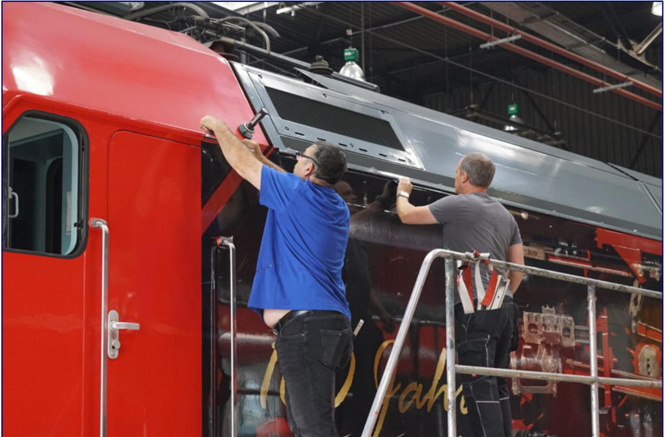
Die vierte Rolle wird verarbeitet. Im Bild zu sehen ist neben dem Lüfter im Dachbereich auch einer der Stabmagnete, mit denen die Klebefolien vor Abziehen der Schutzfolie fixiert werden, um sie zunächst auszurichten.
